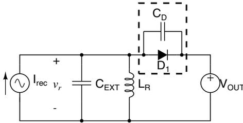
Fig. 3. Resonant rectifier.
