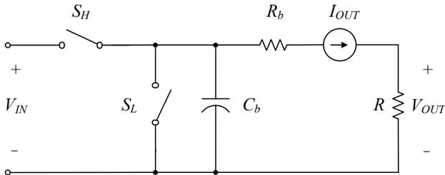
Fig. 14. Buck Converter Model
